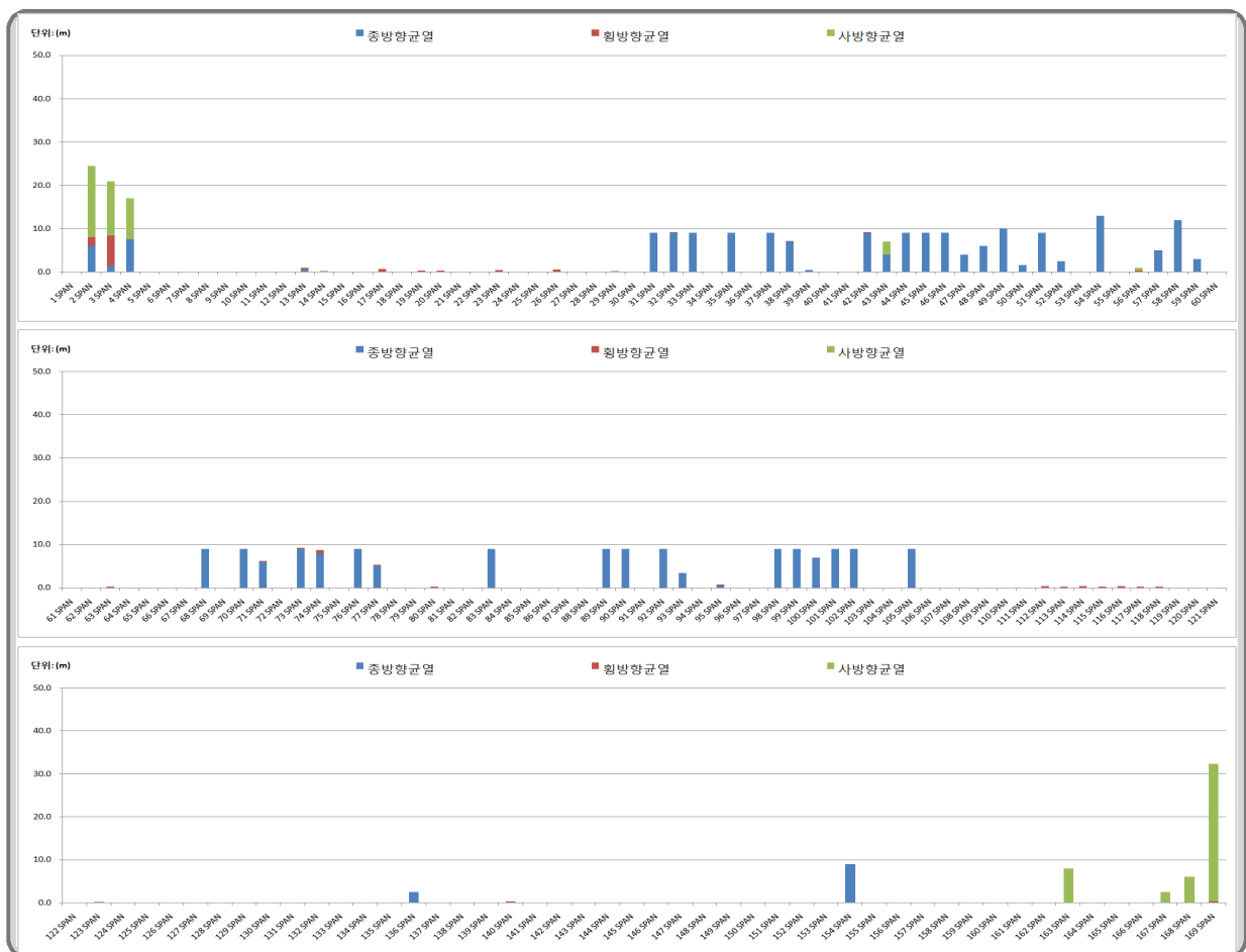
〈그림 3.3〉 본선 콘크리트 라이닝(부산) 유형별 균열 분포현황
